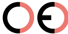
Marca CE falsa (demasiado lejos)
